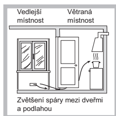
Příklady ventilačních otvorů pro vzduch podporující hoření
