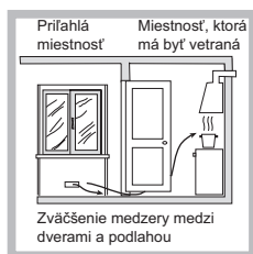
Príklady ventiláčnych otvorov pre vzduch podporujúci horenie
