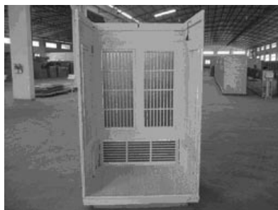
OBR-7 Montáž pravé desky
