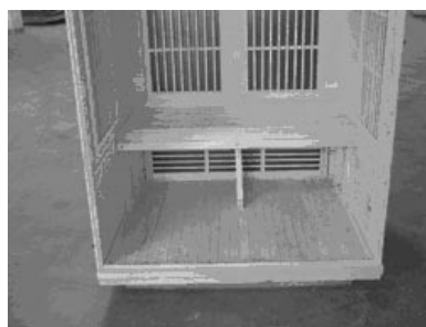
OBR-8 Montáž sedací desky
