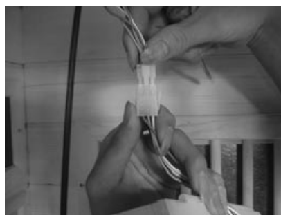
OBR-17 Připojení konektorů k ovládacímu panelu.
